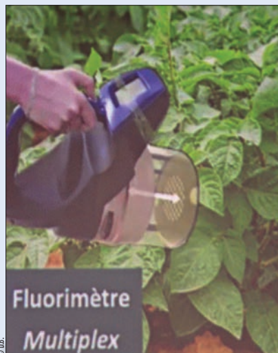
Les chercheurs du CRA-W utilisent un fluorimètre pour le pilotage de l'azote.
